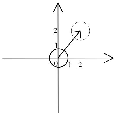
**D2.1 (Vektor):** Ein Vektor gibt die Richtung und die Länge einer *Verschiebung* eines Punktes an. In der Ebene lässt er sich durch einen Pfeil darstellen. Die Spitze des Pfeils gibt dann die Richtung des Vektors und somit der Verschiebung an.
