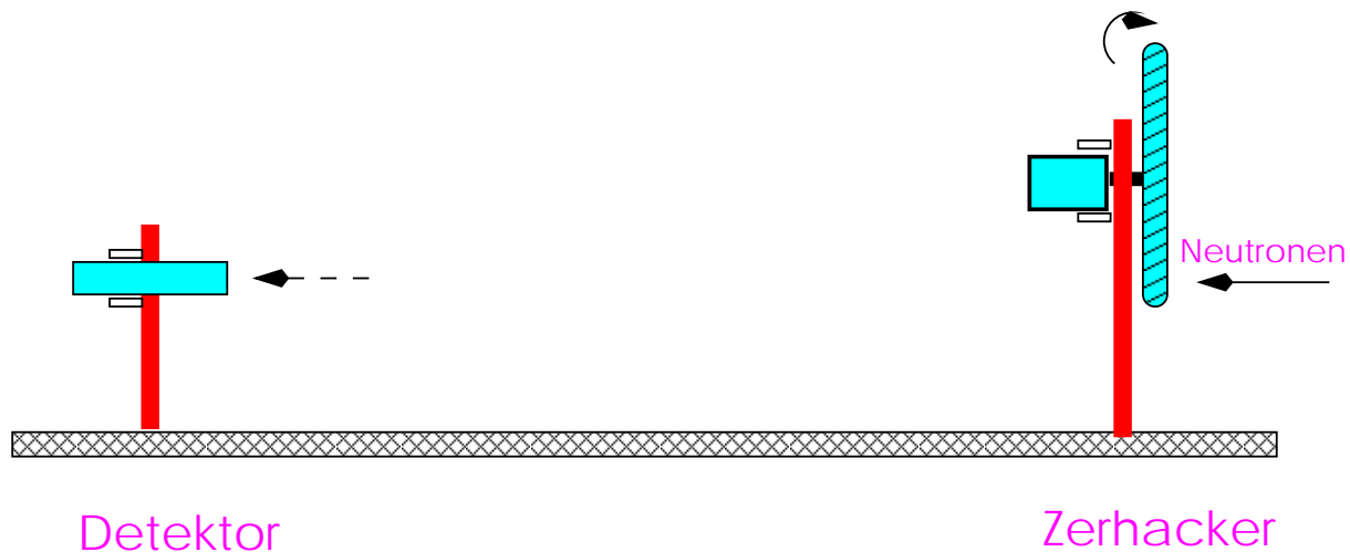
Abbildung 7: Versuchsaufbau zur Messung des Flugzeitspektrums der Neutronen.
